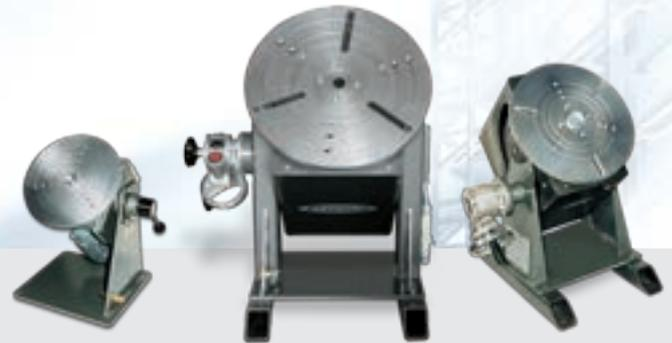
/ Drehkipptische FTT 10/40/150 sind universell für manuelle und mechanisierte Schweißanwendungen sowie zum exakten Positionieren von Werkstücken einsetzbar.
